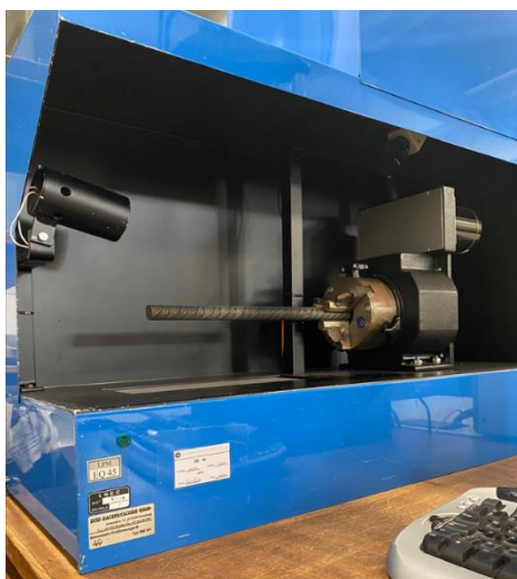
Figura 3: Sistema de medição óptica de varão metálico
