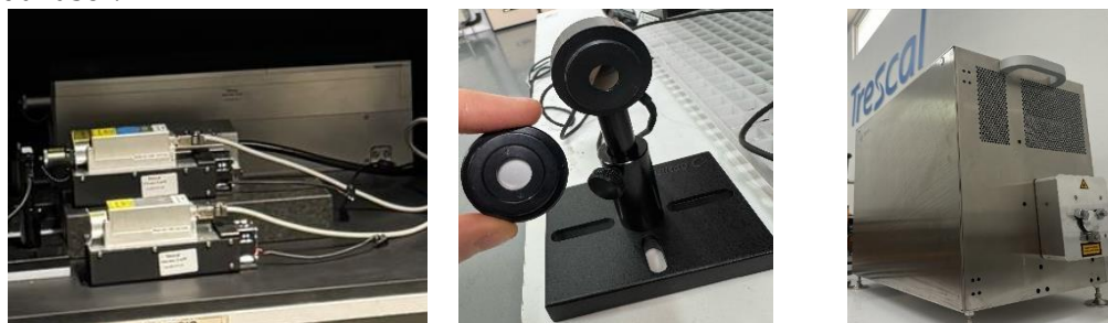
Figura 1 esquerda: laser sólido azul de 473 nm, centro: laser de 1064 nm e direita: sensor de medição de potência, do Laboratório de Óptica da Trescal Portugal
